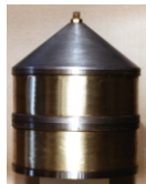
jezgro separatora (permanentni magneti)
